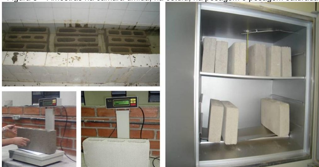
Figura 3 – Amostras na câmara úmida, na estufa, na pesagem e pesagem saturada
