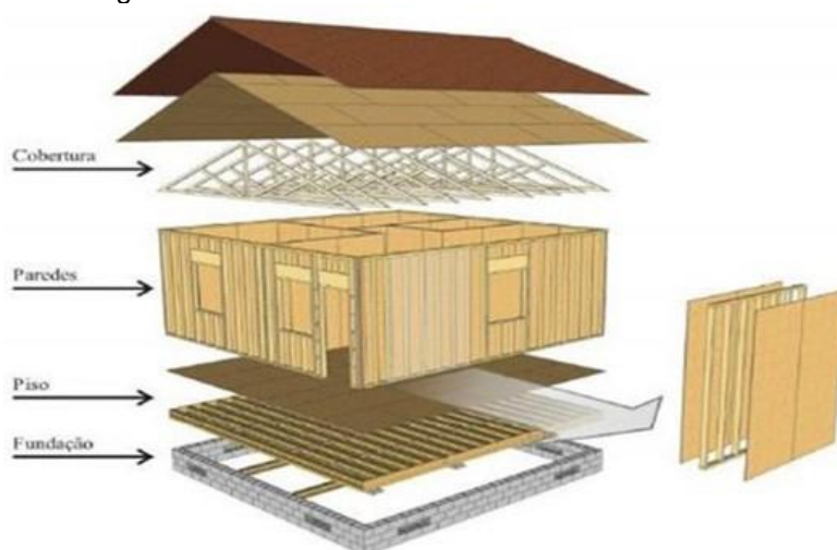
Figura 3: Subsistemas estruturais de uma Wood Frame
