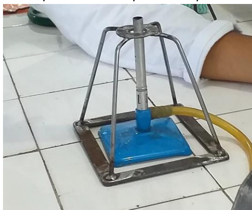
Figura 2 - Soporte de hierro para la boquilla de Bunsen.
