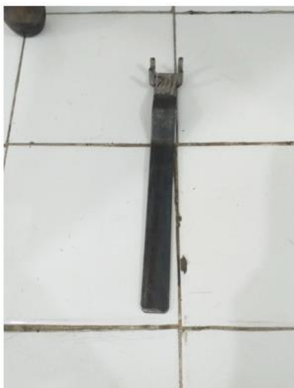
Figura 4 - Palanca a adaptar al grifo de salida de gas, de forma que el alumno tuviera autonomía en relación a la apertura y cierre del gas.
