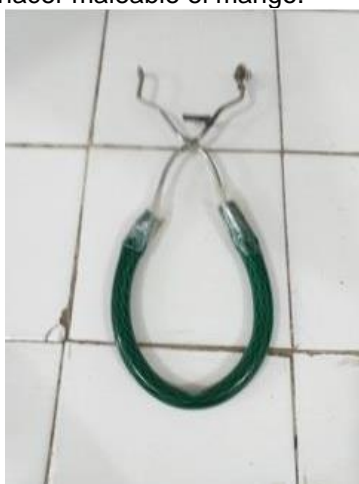
Figura 5 – Pinzas de acero con dos adaptaciones: cerradura de hierro (para no romper el vaso de precipitados) y tubo de plástico para hacer maleable el mango.
