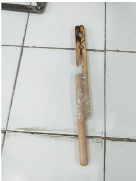
Figura 6 - Pinzas de madera con una extensión para que sea más cómoda y segura para el estudiante.
